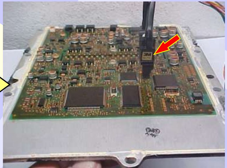
Posição da Pinça Soic 8 na Memória SMD 93C86
