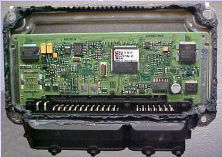
Placa de Circuito da Central Bosch Motronic ME 7.5.30
