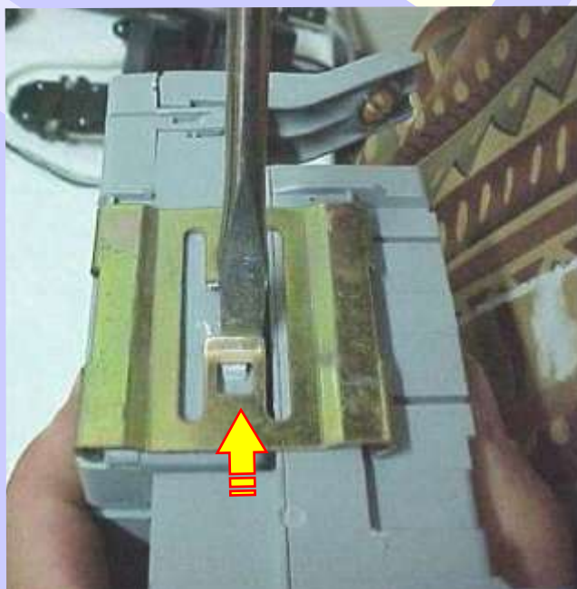
Separando o computador de bordo da caixa de fusíveis.
