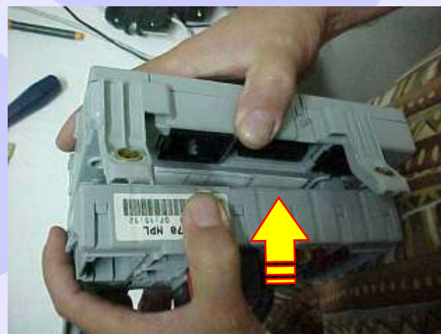
Removendo as travas para separar o BC da caixa de fusíveis
