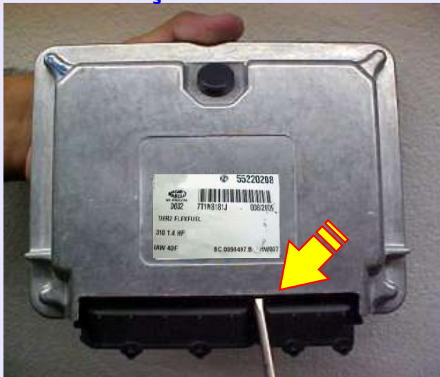
Modo correto de terminar de abrir a Central Magneti Marelli IAW 4DF
