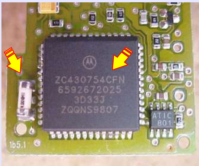
Visualizando o circuito com o microprocessador Zc430754 e o cristal oscilador
