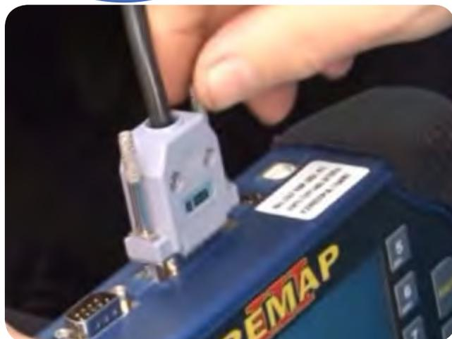
1º Conecte o cabo de diagnóstico na REMAPIII e aperte os parafusos para que o cabo não saia da máquina.
