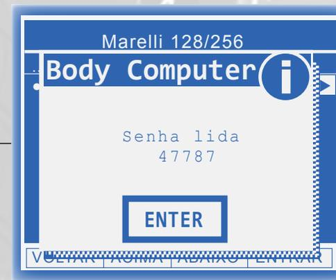
Sempre quando for feito algum procedimento de diagnóstico especial, deve -se desconectar o conector por 10 segundos. **Importante: Nunca desconecte o conector com a ignição ligada.**
