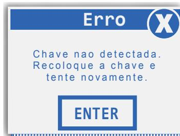
**FALHA:** Esta falha indica que o transponder utilizado no procedimento apresenta algum problema.
