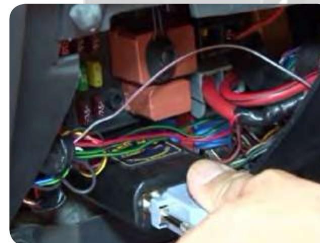
4º Após retirado o compartimento como mostra na imagem anterior, conecte o OBDII na tomada de diagnóstico.
