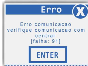
**FALHA 91:** Esta falha indica que o não foi possível realizar a leitura dos dados do body computer.
