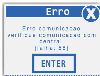
**FALHA 88:** Esta falha indica que não houve resposta de comunicação com o módulo.
