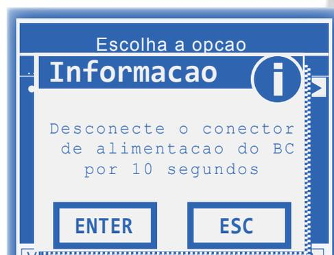
Neste momento deve-se desconectar a alimentação do conector e aguardar 10 segundos como mostra a imagem na pagina 15. Após desconectar e aguarda 10 segundos ligue novamente o conector de alimentação e vá para o proximo passo que será a apresentação das chaves.
