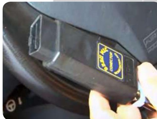
2º conecte o cabo de diagnóstico no conector especial para este veículo, que no caso é o OBDII MIC, como mostra na imagem ao lado, e aperte os parafusos
