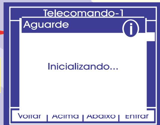
Se o procedimento anterior não for realizado corretamente ou não houver contato com a central do veículo, aparecerá esta mensagem e relatado o o numero da falha que está impedindo a realização do procedimento. Tecl **ENTER** e volta ao 9º passo.
