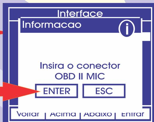
Neste momento deve-se inserir o conector OBD II MIC para continuar o procedimento. aperte **ENTER** para verificar o conector. . Apertando **ESC** vai para o 9º Passo.
