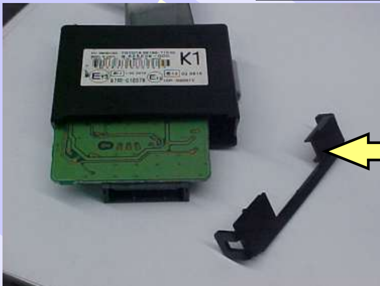
Retirando a placa de circuito do imobilizador
