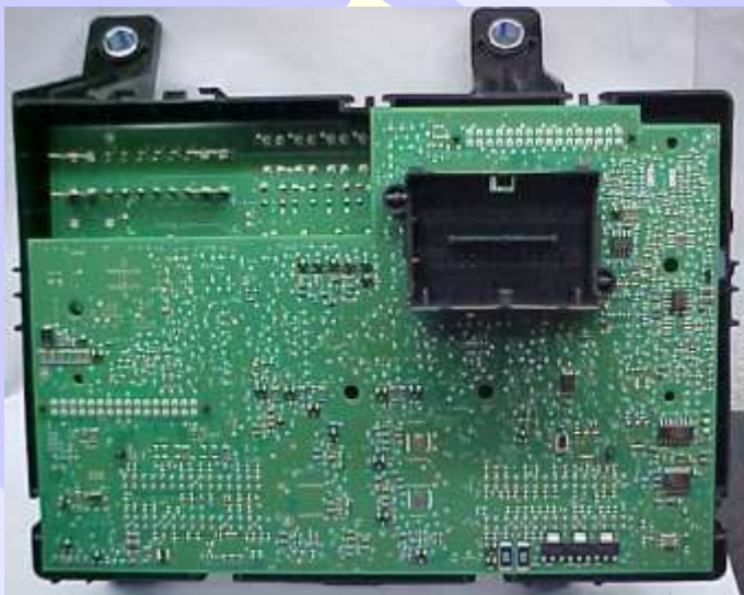
Body Computer BC Marelli 326G aberto e mostrando a placa de circuito
