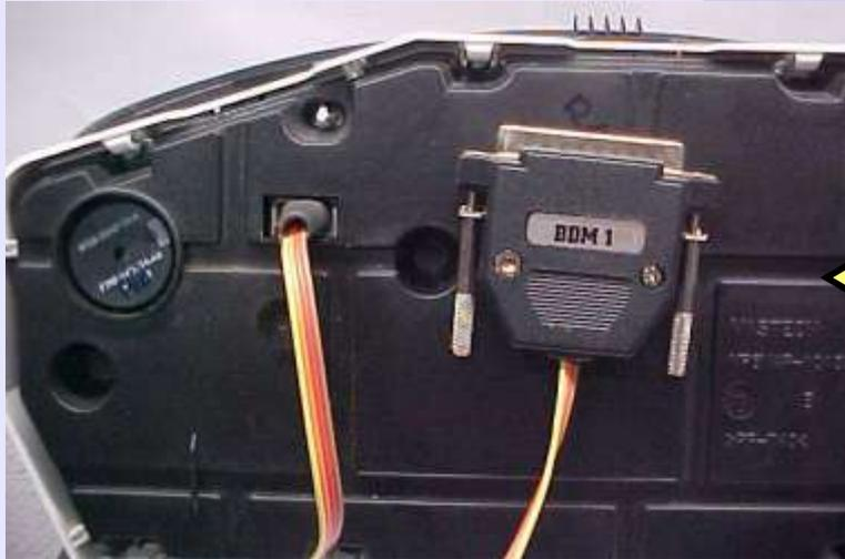
Usando cabo BDM1, quando o painel tem o conector BDM
