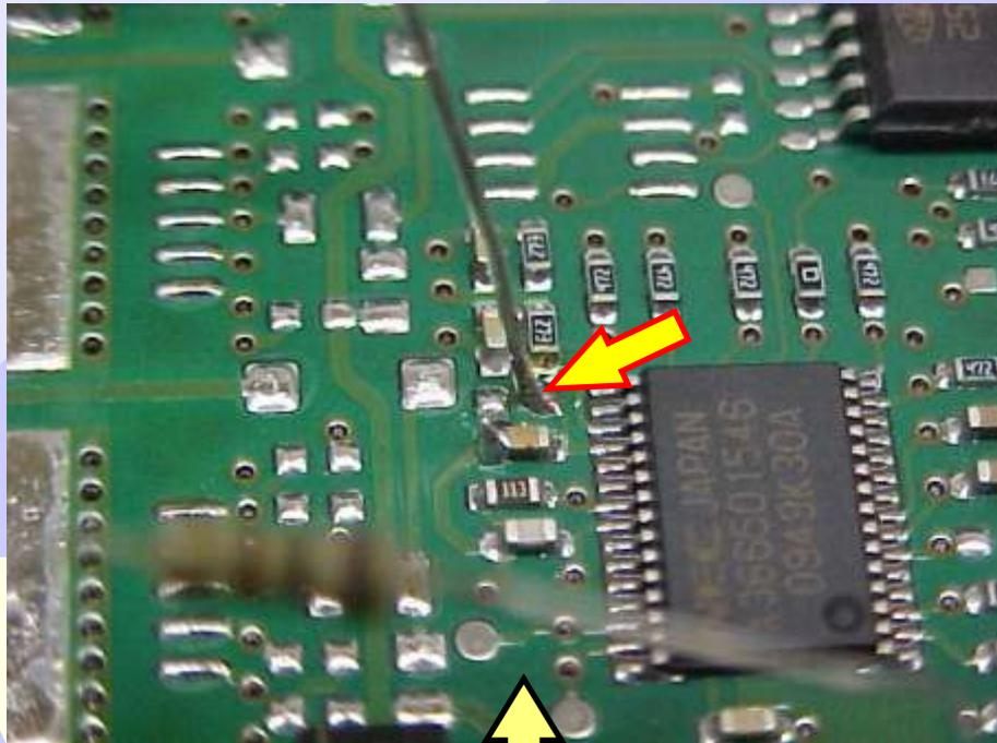
Posição da solda do resistor 560R
