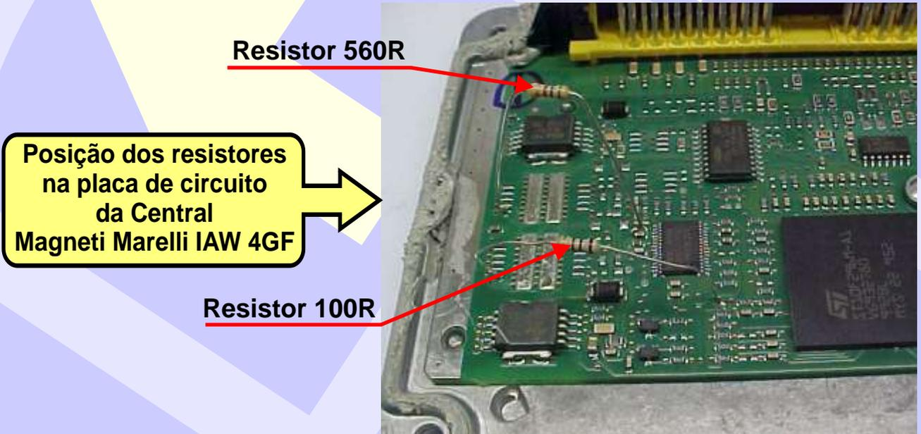
Posição dos resistores na placa de circuito da Central Magneti Marelli IAW 4GF
