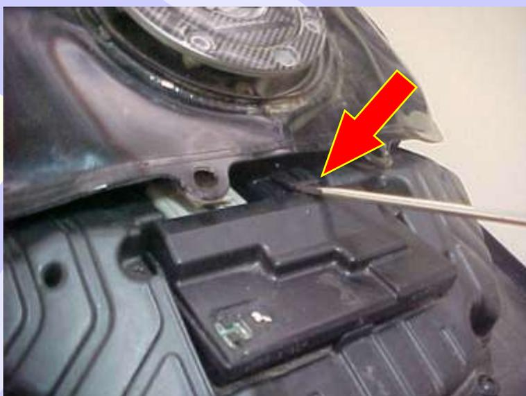
Levantando a trava do conector cinza da ECU do motor
