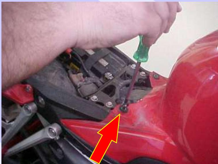
Retirando o parafuso da tampa do tanque
