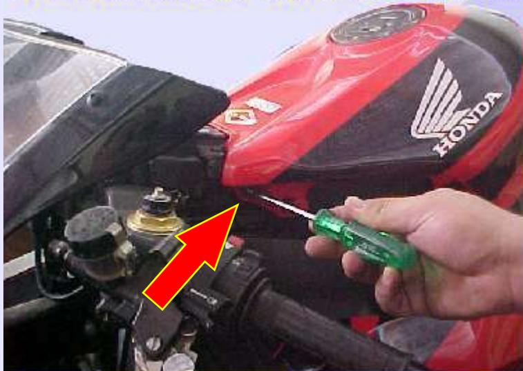
Retirando o parafuso do lado esquerdo da tampa do tanque
