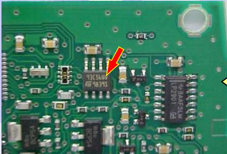
Ilustração mais detalhada da memoria SMD 93C56 na Placa De Circuito do Imobilizador P8200900862K
