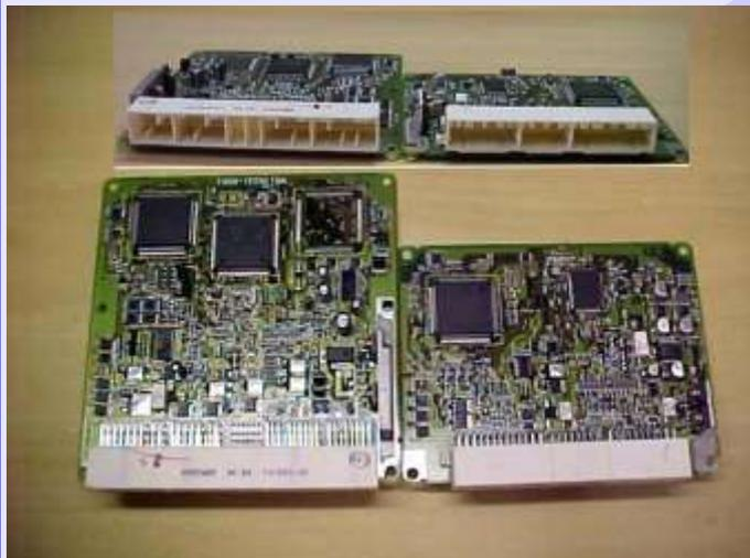
A figura ao lado mostra dois modelos de Central Toyota uma com 3 encaixes e outra com 4 encaixes.
