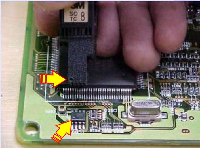
← Posição de encaixe da Pinça Soic 8 na memória a ser Programada
