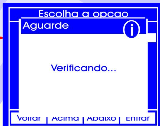
**ATENÇÃO:** Nos passos 3, 4 e 5, é verificado se o Conector OBD II MIC, está conectado, caso não esteja irá usar o Conector OBD II antigo.
