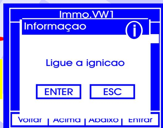
Neste momento deve-se ligar a ignição para dar continuidade ao procedimento. Aperte **ENTER** para continuar o procedimento. Apertando ESC volta ao 1º Passo.
