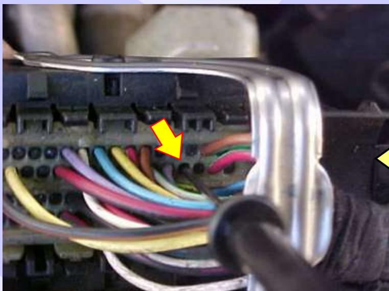
Introduzir a Agulha do Cabo EB12 no Pino 20 do Conector B da ECU do Palio ME 73H4 (Visualização mais ampliada e mais detalhada)
