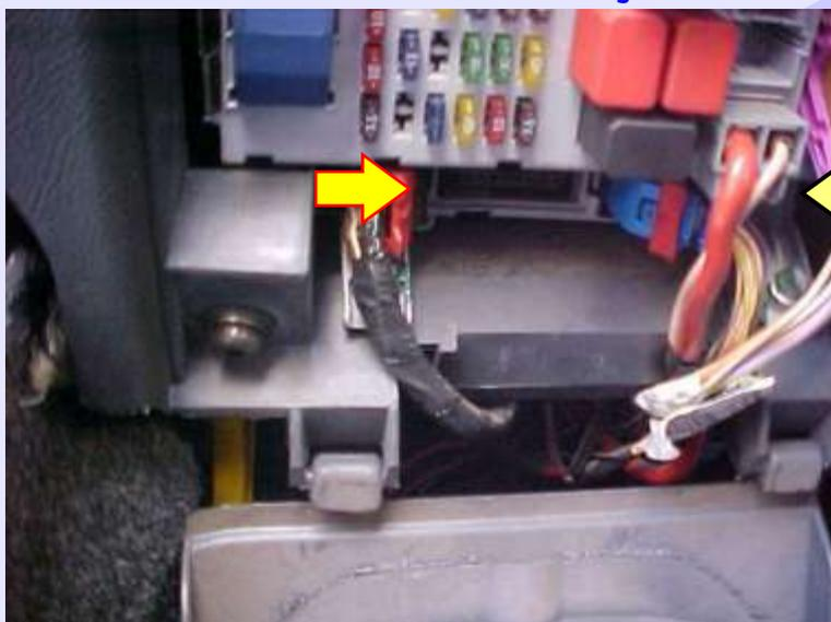
Localização do conector de diagnostico do Palio 1.3 16V local do lado esquerdo da coluna de direção
