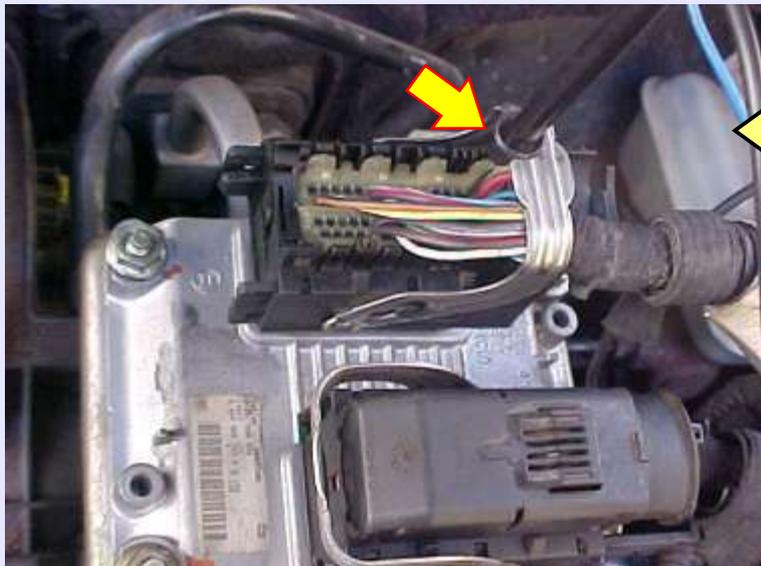
Introduzir a Agulha do Cabo EB12 no Pino 20 do Conector B da ECU do Palio ME 73H4
