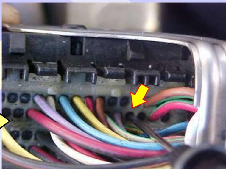
Introduzir a Agulha do Cabo EB12 no Pino 20 do Conector B da ECU do Palio ME 73H4 (Visualização mais ampliada)
