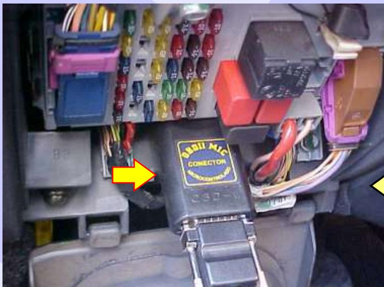
Usando Conector OBDII MIC (Visualização mais Ampliada)
