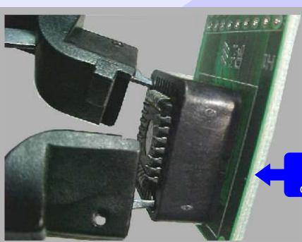
Retirando o Microprocessador com o Soquete 2 Gold
