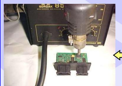
Soprando ar quente nos terminais do Microprocessador do Imobilizador VW siemens
