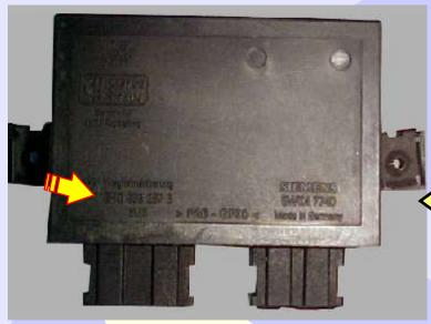
Identificação do Imobilizador VW SiemensTMS 370 6H0953257B
