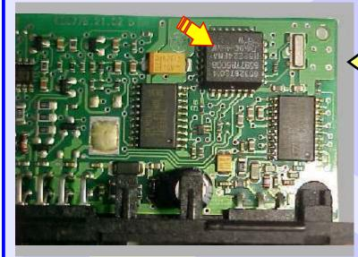
Microprocessador a ser retirado do Imobilizador VW siemens
