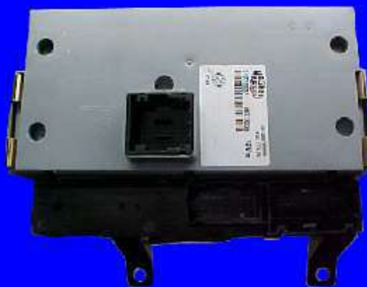
BODY COMPUTER - MICROPROCESSADOR MC9S12DG256 FIAT FAMÍLIA NBC178 (PALIO, SIENA, STRADA, DOBLO, IDEA - ANO 2004 À 2007)
