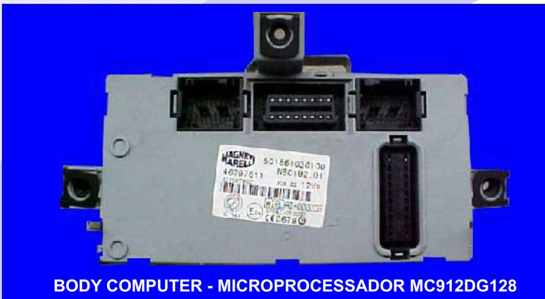
**BODY COMPUTER - MICROPROCESSADOR MC912DG128**
