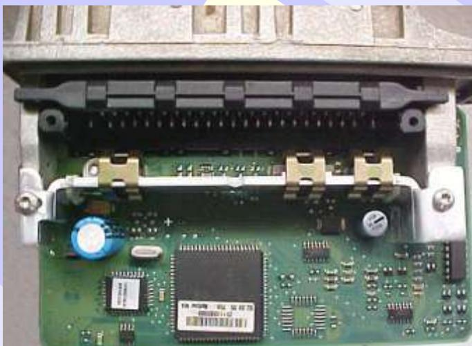
Central Bosch Motronic MP 9.0 aberta visualizando a Placa de Circuito
