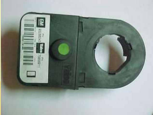
Localização do Imobilizador GM S10 e Blazer Obs: Para retirar o Imobilizador deve-se tirar primeiro o tambor de ignição.
