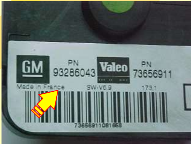
Localização do Imobilizador GM S10 e Blazer Obs: Para retirar o Imobilizador deve-se tirar primeiro o tambor de ignição.
