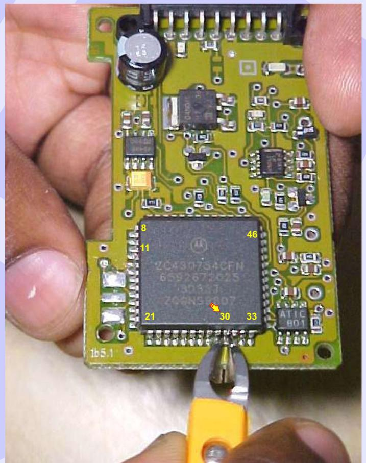
CORTANDO O PINO 30 DO MICROPROCESSADOR (Usar alicate pequeno tipo usado para tirar cutícula)
