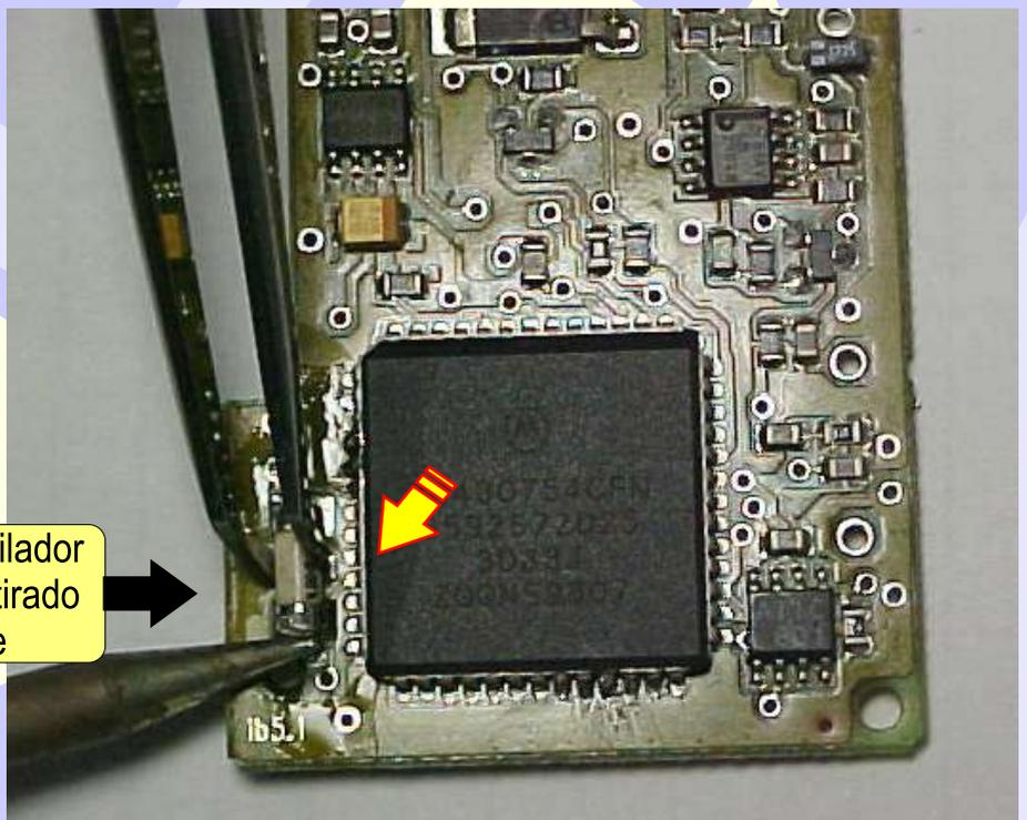
Voltar com o Cristal Oscilador para o local onde foi retirado e soldar novamente
