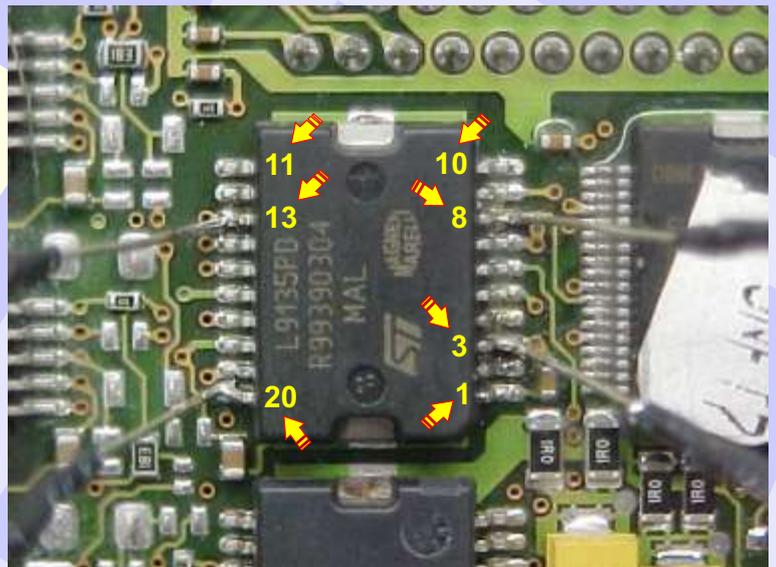
Fio azul na ilha da placa conforme ilustrado na foto
