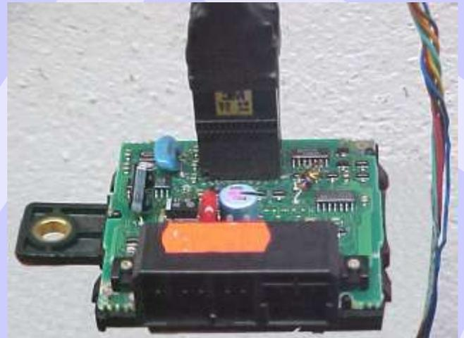
Vizualização mais ampliada da aplicação da Pinça Soic 8 no Microprocessador
